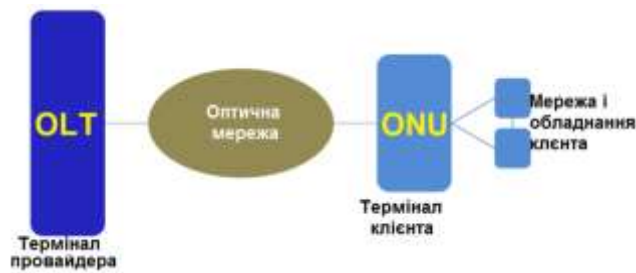
Рисунок 39 – Загальна схема PON
