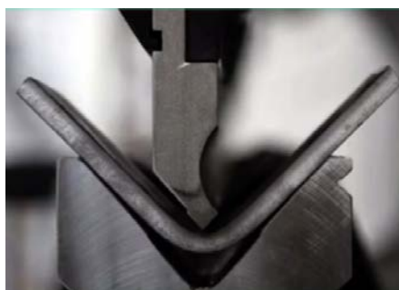
Рис. 3.10. Гнуття по радіусу (а), в кут (б)
