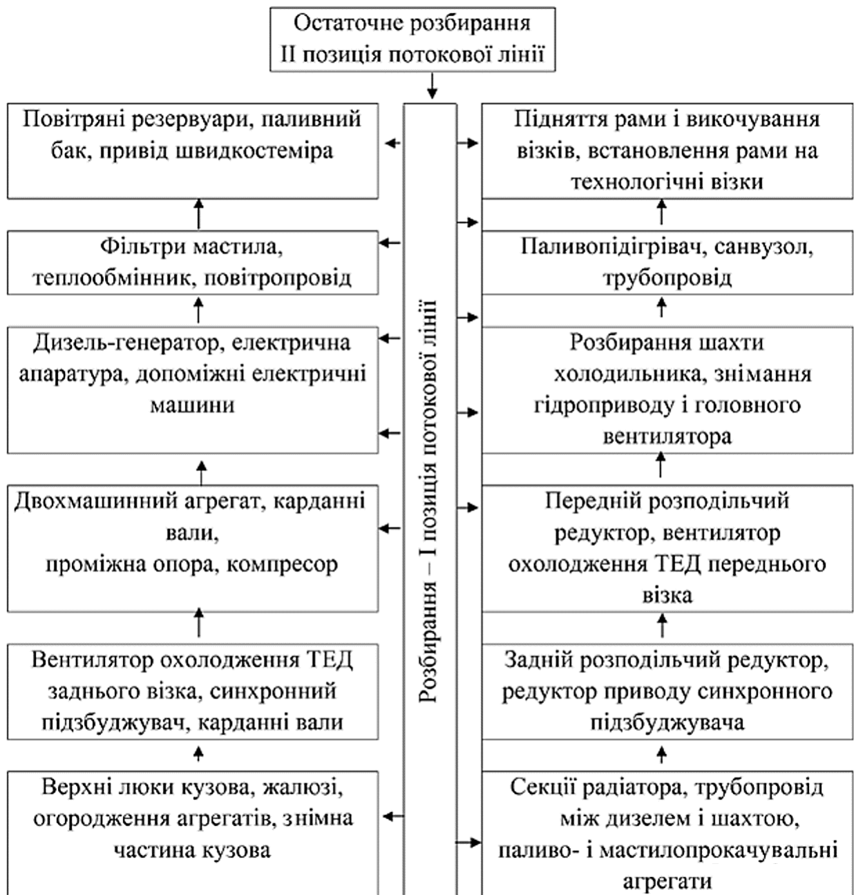
Рис. 3.4. Схема розбирання секції тепловоза серії 2TE10Л
