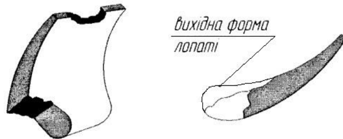
Рис. 8.15. Схема лопаті насоса з пошкодженням
