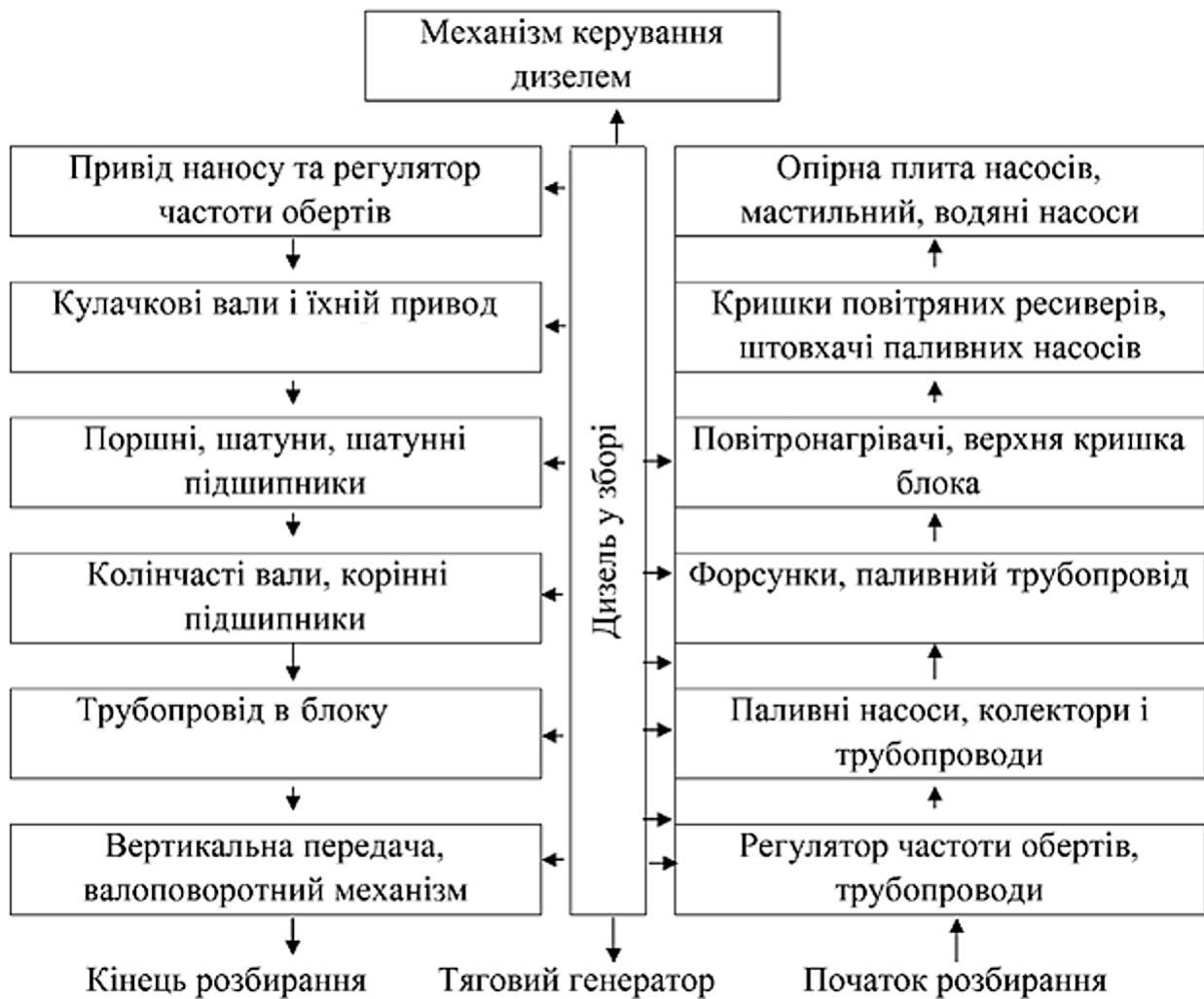
Рис. 3.5. Схема розбирання дизеля типу 10Д100
