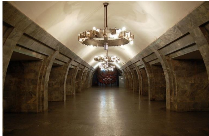
Рис. 1.8. Станційний тунель метрополітену трьохсклепінчастої пілонної станції ( https://surl.li/pfhymq )
