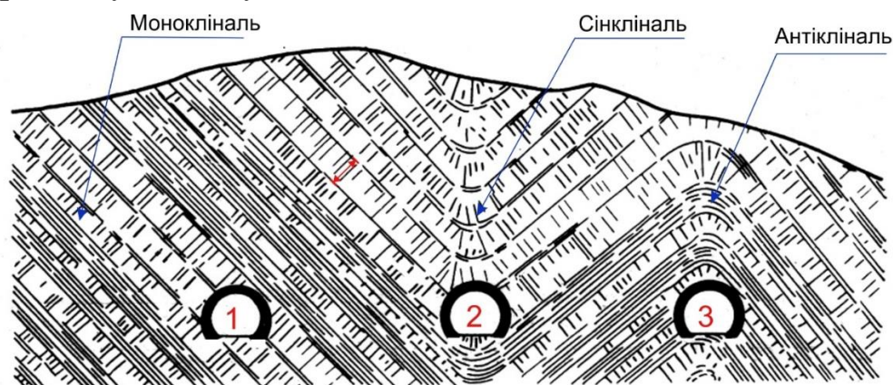
Рис. 2.17. Варіанти трасування тунелів в залежності від розташування дислокацій
