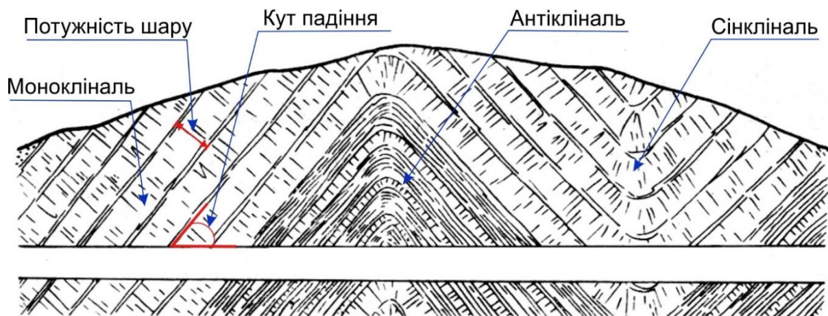
Рис. 2.15. Пересічення тунелем нерозривної дислокації (складки)
