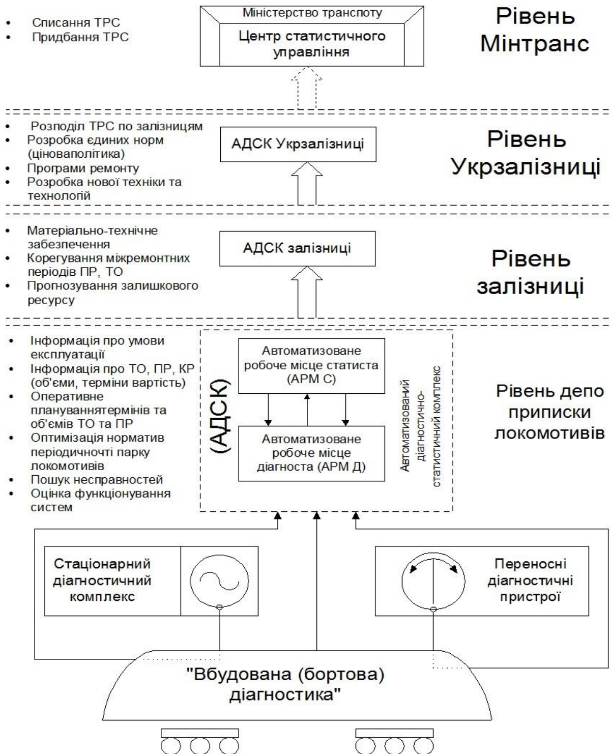
Рисунок 2.26 – Схема основних потоків діагностичної інформації та прийняття рішень по технічному стану парку локомотивів
