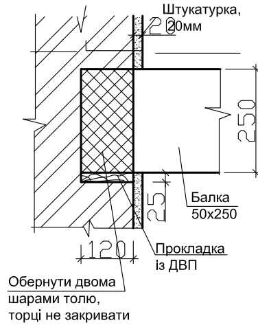
Деталь кріплення балки під тягиву до міжповерхового перекриття
