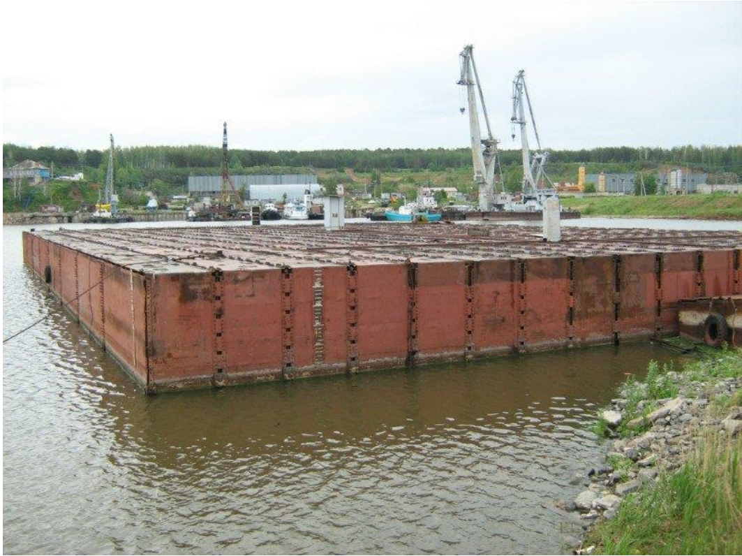
Рис. 16.5. Плашкоут з понтонів
