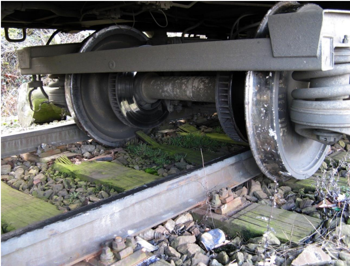
Рис. 4.2. Сліди взаємодії на колесі та елементах верхньої будови колії
