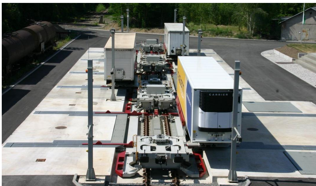
Рис. 7.16. Навантаження напівпричепів на вагони системи CargoBeamer
