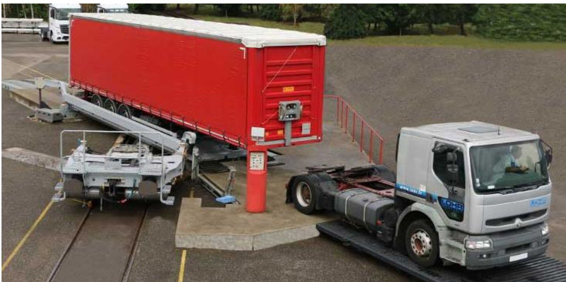
Рис. 7.15. Положення поворотної платформи Modalohr у вантажному положенні
