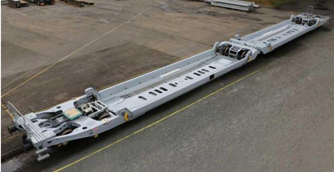
Рис. 7.14. Подвійний зчленований вагон Modalohr
