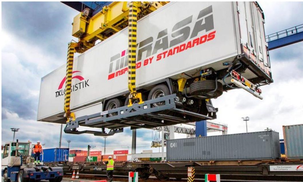
Рис. 7.11. Напівприцеп на піддоні NiKRASA 3.0 компанії TX Logistics
