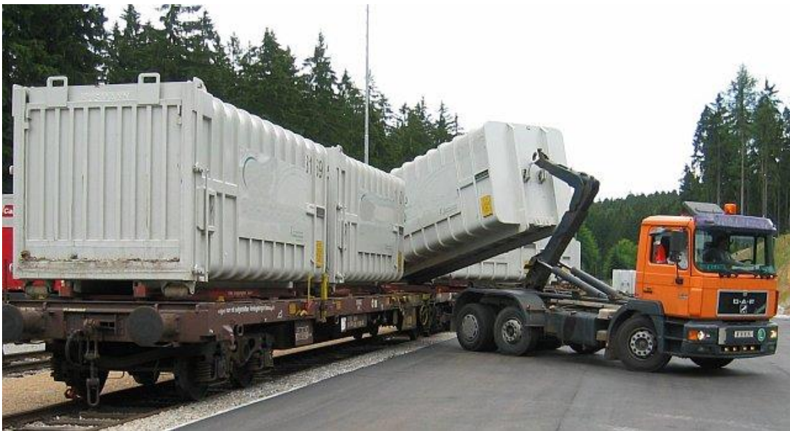
Рис. 7.26. Процес перевантаження контейнера ACTS
