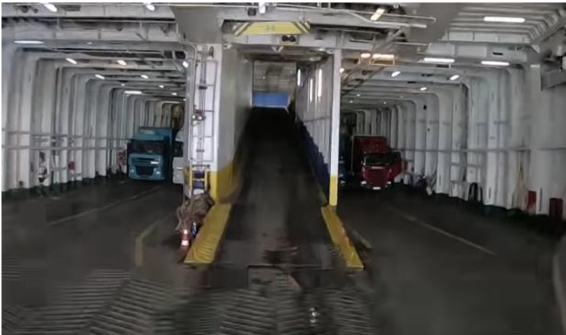
Рис. 9.22. Міжпалубний з'їзд для накочування автомобілів на верхню палубу автомобільного порому
