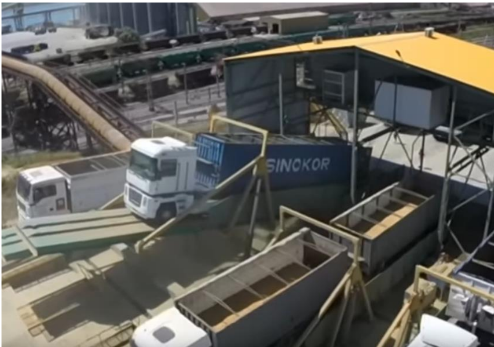
Рис. 7.3. Розвантаження зерна з автопоїздів шляхом їх поздовжнього підйому
