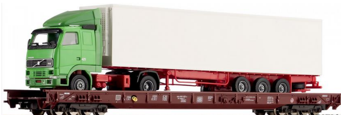
Рис. 7.20. Платформа Ro-La з автопоїздом
