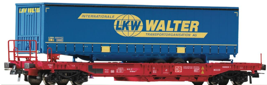
Рис. 7.12. Вагон з поглибленнями для встановлення коліс напівпричепа
