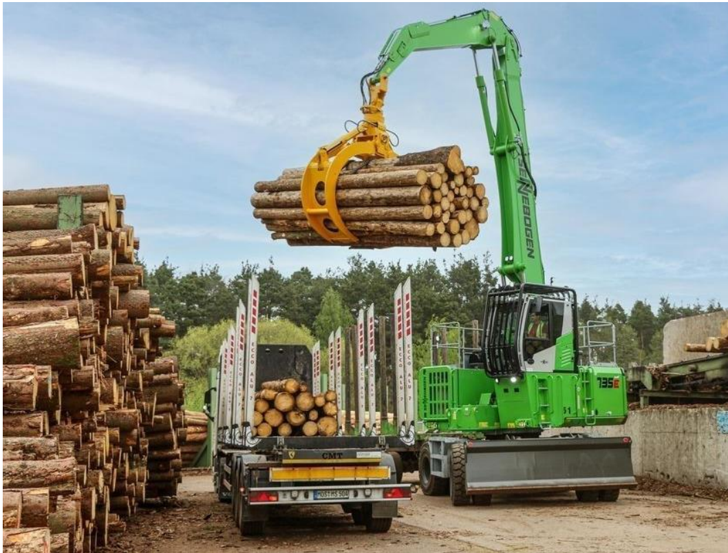
Рис. 7.6. Навантаження лісоматеріалів колісним навантажувачем із спеціальним захватом
