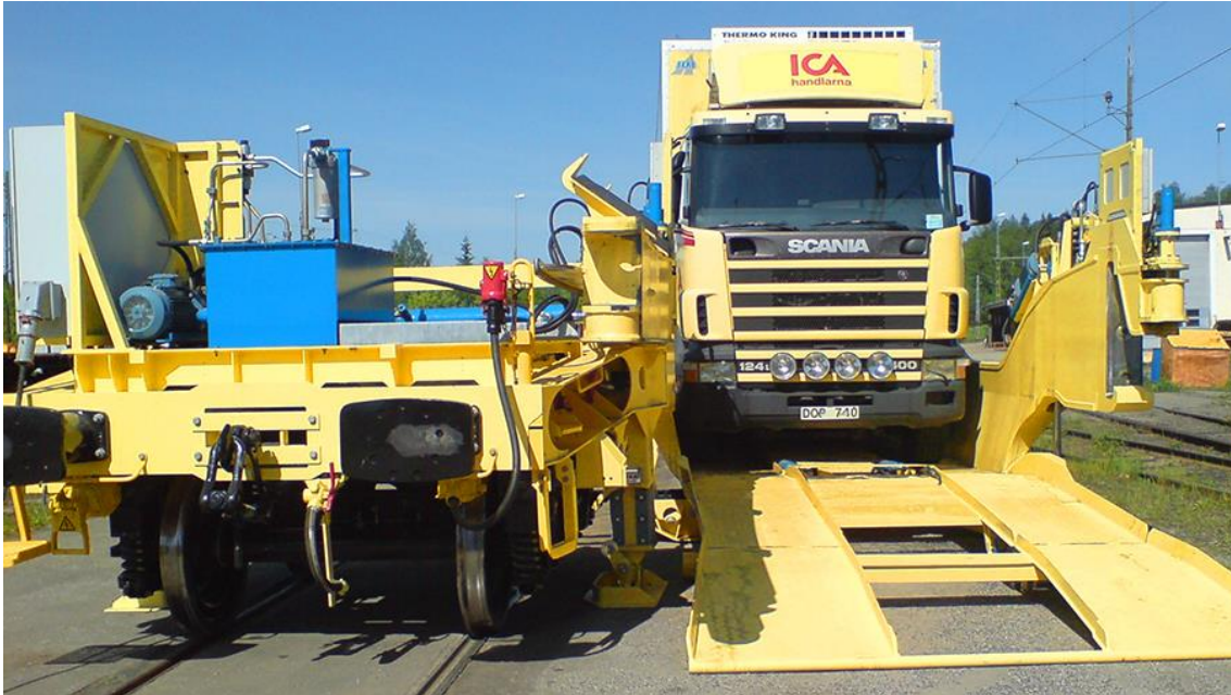
Рис. 7.19. Виконання вантажних операцій з вагоном Flexiwaggon
