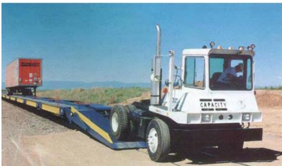
Рис. 7.17. Виконання вантажних операцій з модулем Iron Highway
