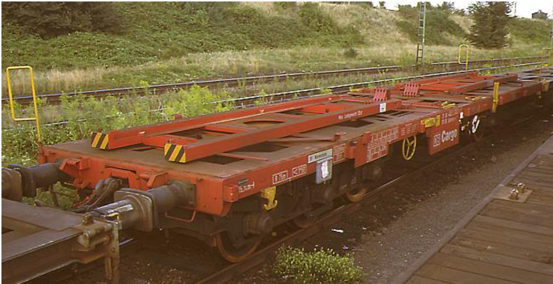
Рис. 7.25. Платформа з поворотними рамами ACTS
