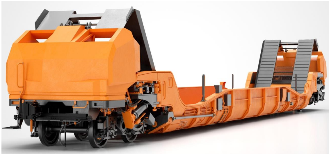
Рис. 7.18. Вагон системи Flexiwaggon
