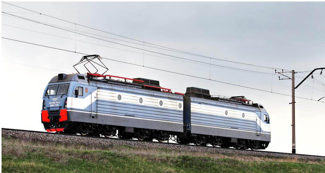
Рисунок 4.4 – Загальний вигляд електровоза постійного струму ВЛ11М6
