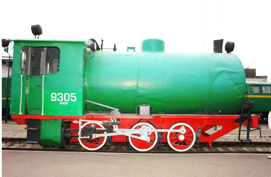
Рисунок 4.6 – Загальний вигляд безтопкового локомотива
