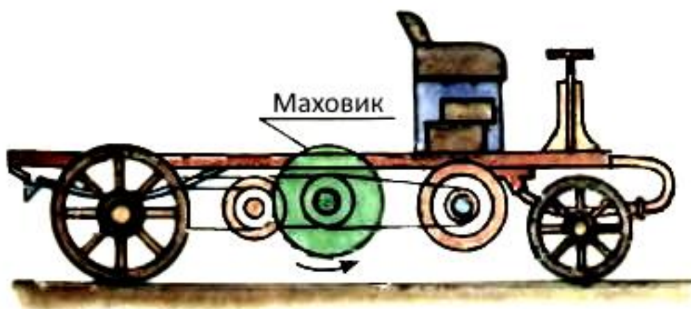
Рисунок 4.26 – Концептуальна схема та принцип дії жиробуса
