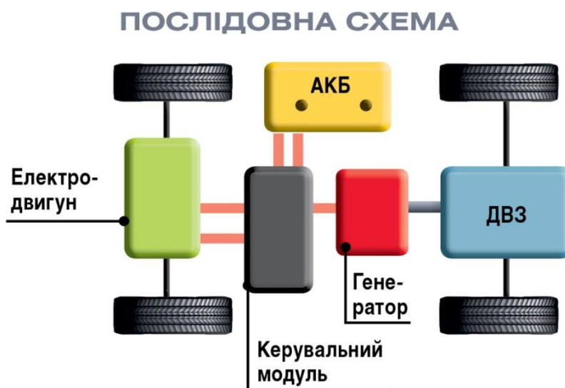
Рисунок 4.11 – Принципова схема послідовного гібридного автомобіля
