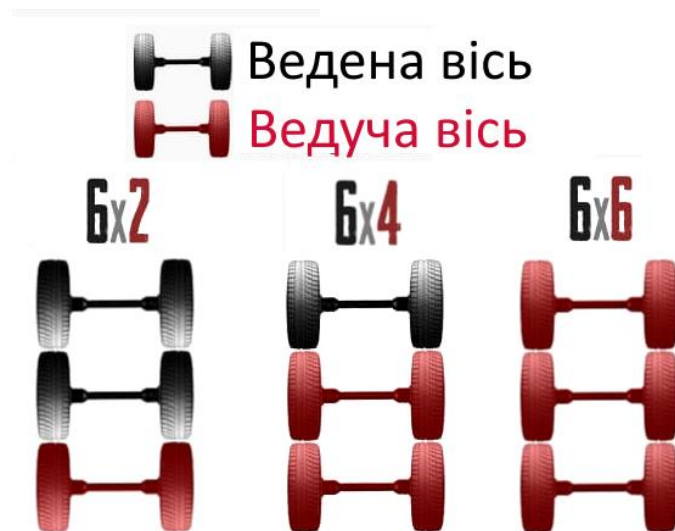
Рисунок 4.8 – Основні осьові формули вантажних автомобілів
