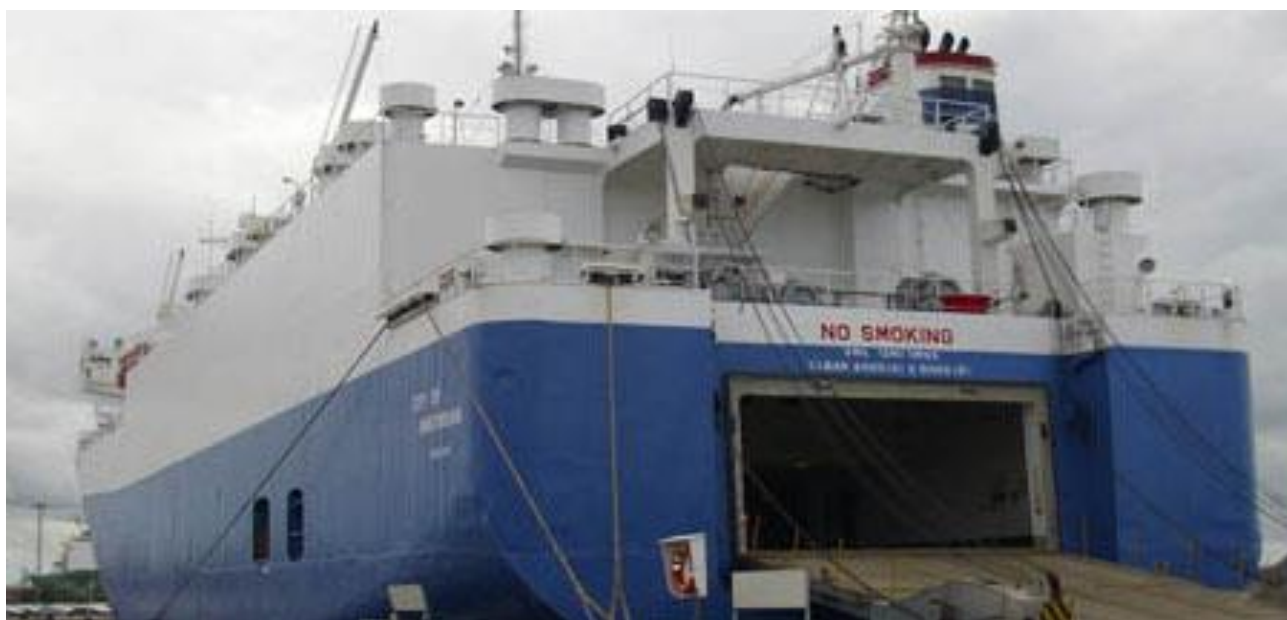
Рисунок 4.14 – судно «Ро-Ро» горизонтального навантаження
