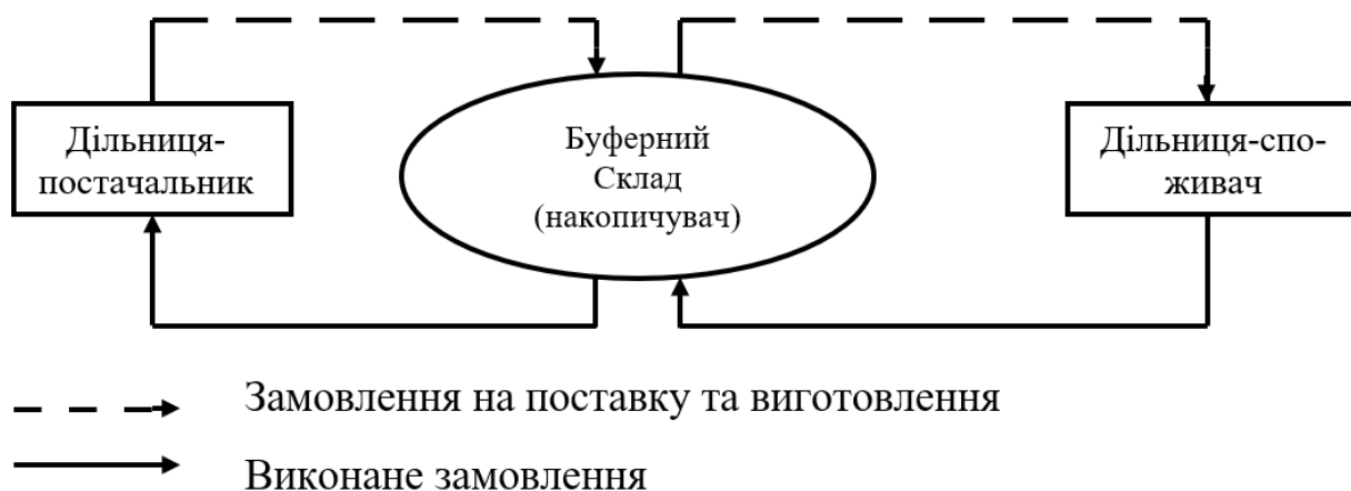
Рисунок 11.5 – Схема об’єднаного контуру регулювання
