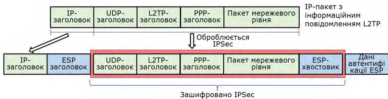
Рисунок 7.21. Приклад використання протоколу L2TP поверх IPsec
