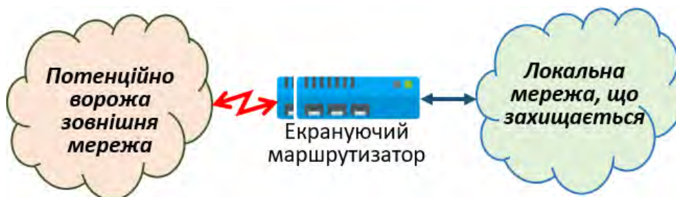
Рисунок 4.8. Схема захисту мережі з використанням екрануючого маршрутизатора
