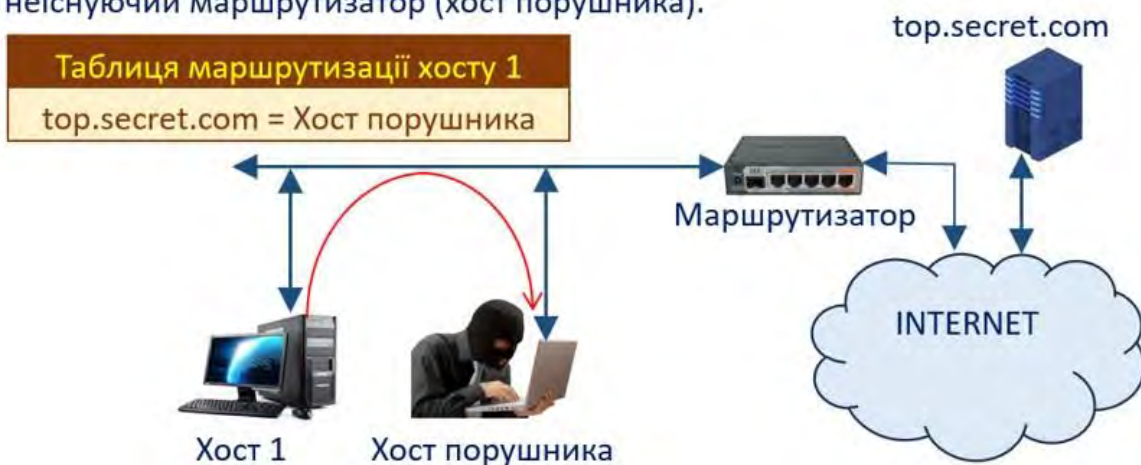
Рисунок 2.5. Атака «Помилковий DNS-сервер»
