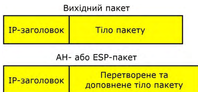
Рисунок 5.7. Транспортний режим IPSec
