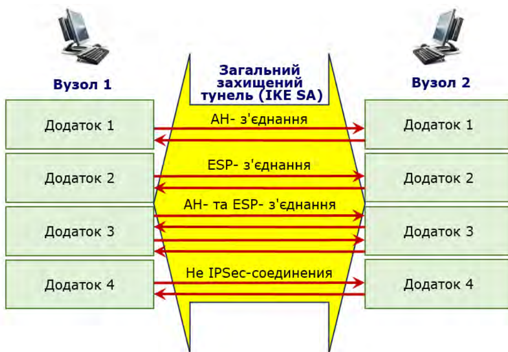
Рисунок 8.8. Формування захищених з'єднань протоколом IKE
