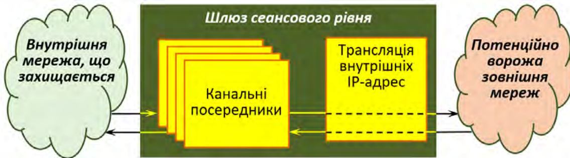
Рисунок 4.6. Схема функціонування шлюзу сеансового рівня
