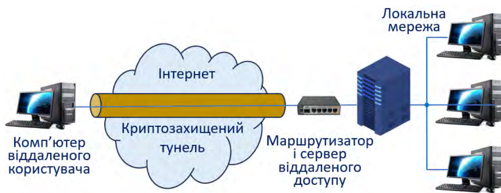
Рисунок 7.13. Схема тунелювання під час прямого підключення комп'ютера віддаленого користувача до Internet
