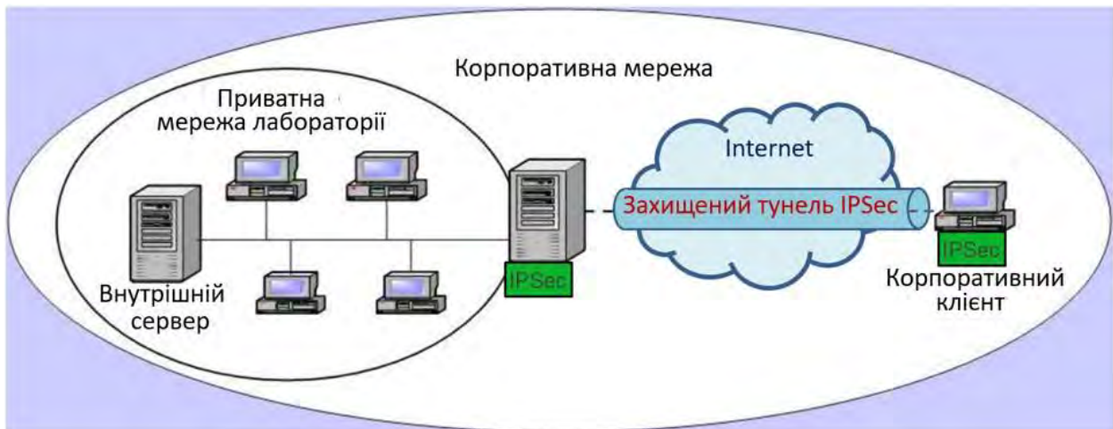
Рисунок 5.11. Схема захисту «шлюз-хост»
