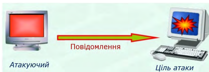
Рисунок 1.8. Атака без зворотного зв'язку
