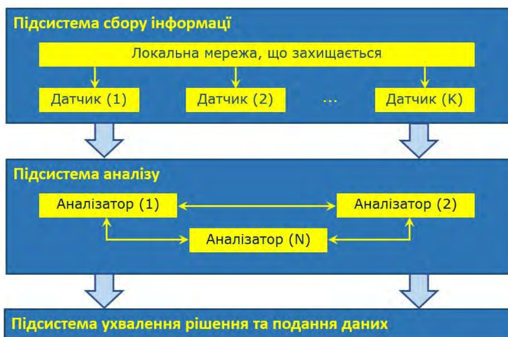
Рисунок 4.15. Структура системи виявлення вторгнень
