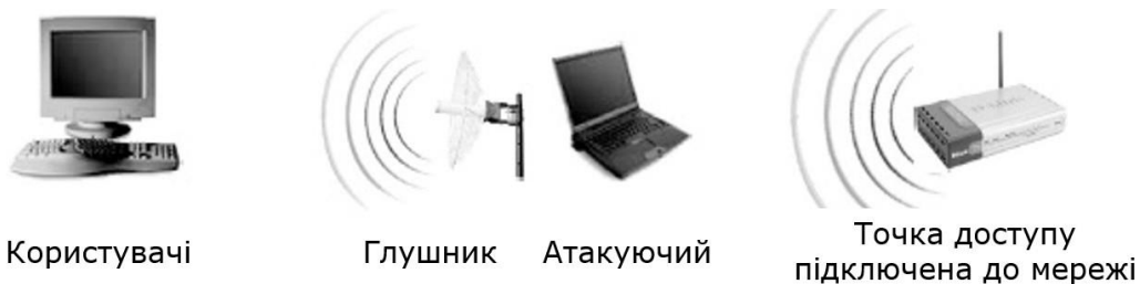
Рисунок 1.11. Атакуючий глушить основний сигнал від точки доступу бездротової мережі
