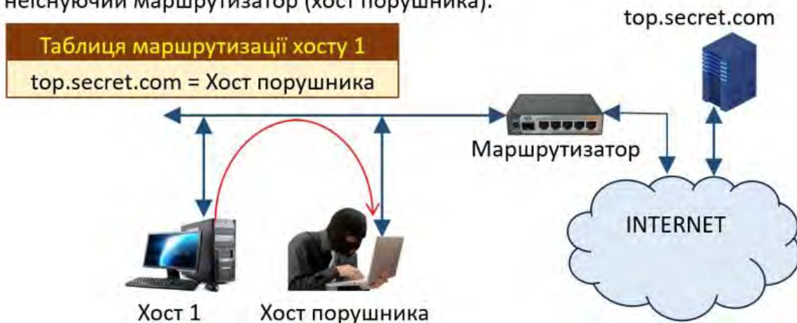
Рисунок 2.4. Нав'язування хосту неправдивого маршруту з використанням протоколу ICMP
