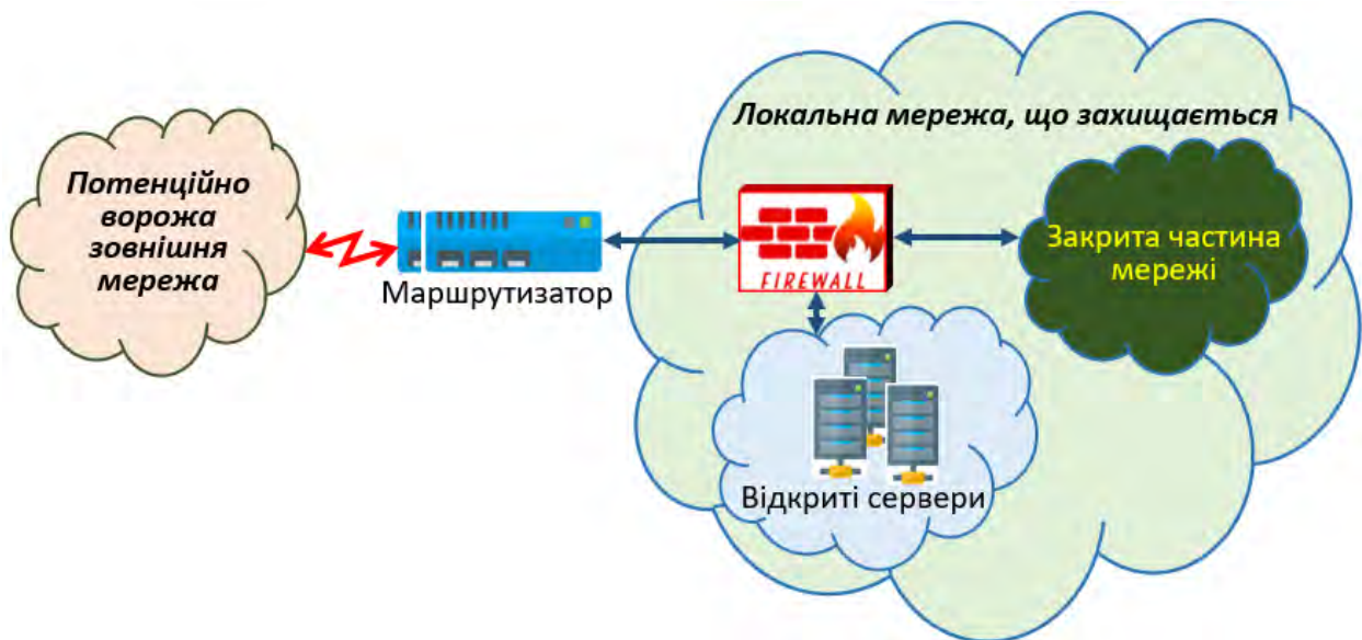
Рисунок 4.11. Схема з роздільним захистом закритої та відкритої підмереж на основі одного брандмауера з трьома мережевими інтерфейсами
