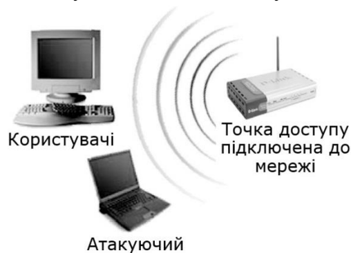
Рисунок 1.12. Прослуховування зловмисником радіохвиль між точкою доступу та користувачами мережі
