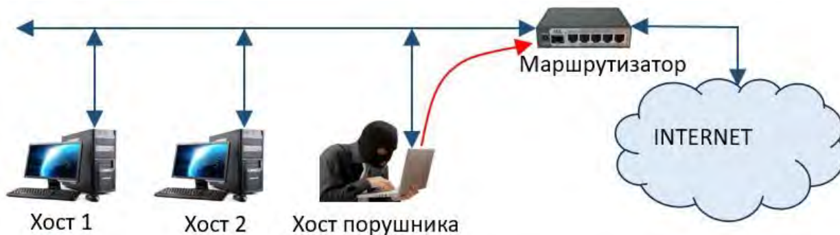
Рисунок 2.2. Хост порушника передає маршрутизатор керуюче повідомлення від імені адміністратора мережі
