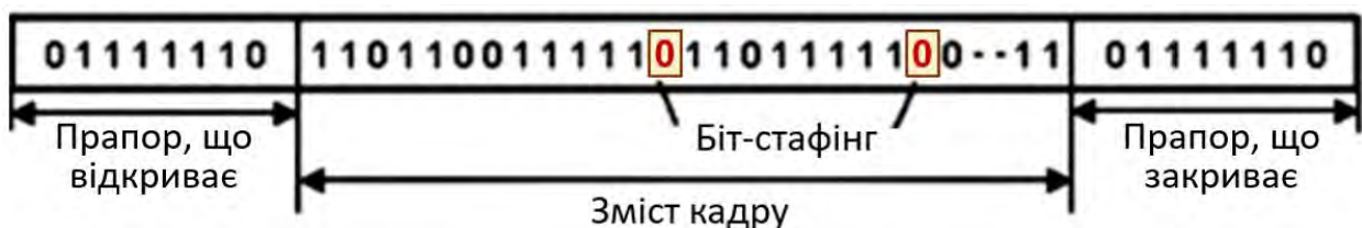
Рисунок 7.4. Використання бітстафінгу в кадрі PPP
