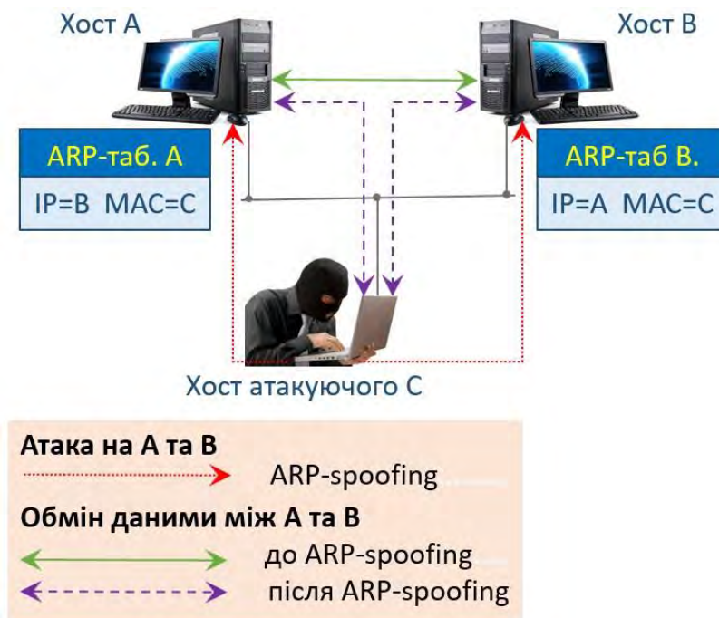
Рисунок 3.6. Схема атаки «ARP-spoofing»
