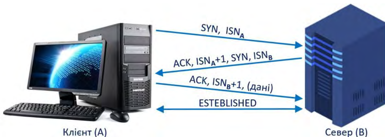
Рисунок 2.1. У процесі створення TCP-з'єднання сторони обмінюються рядом службових повідомлень
