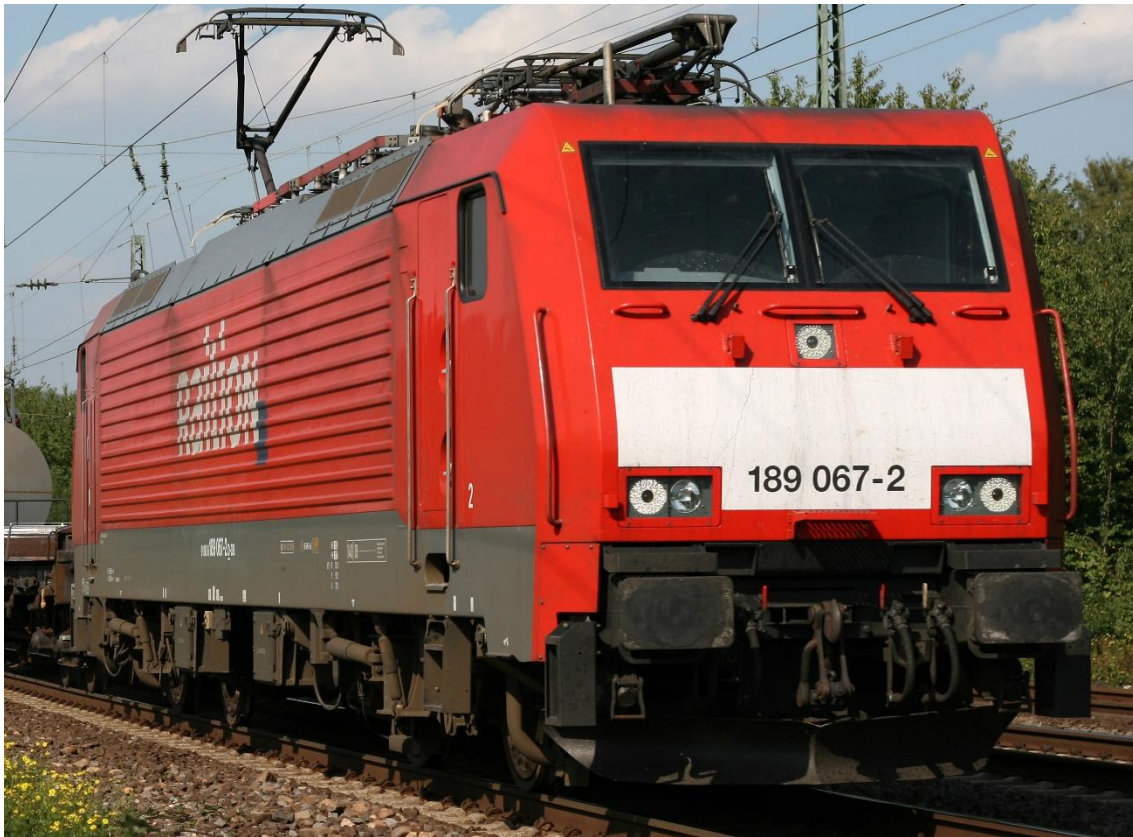
Рис. 8.8. Чотирисистемний вантажний електровоз EuroSprinter ES64F4
