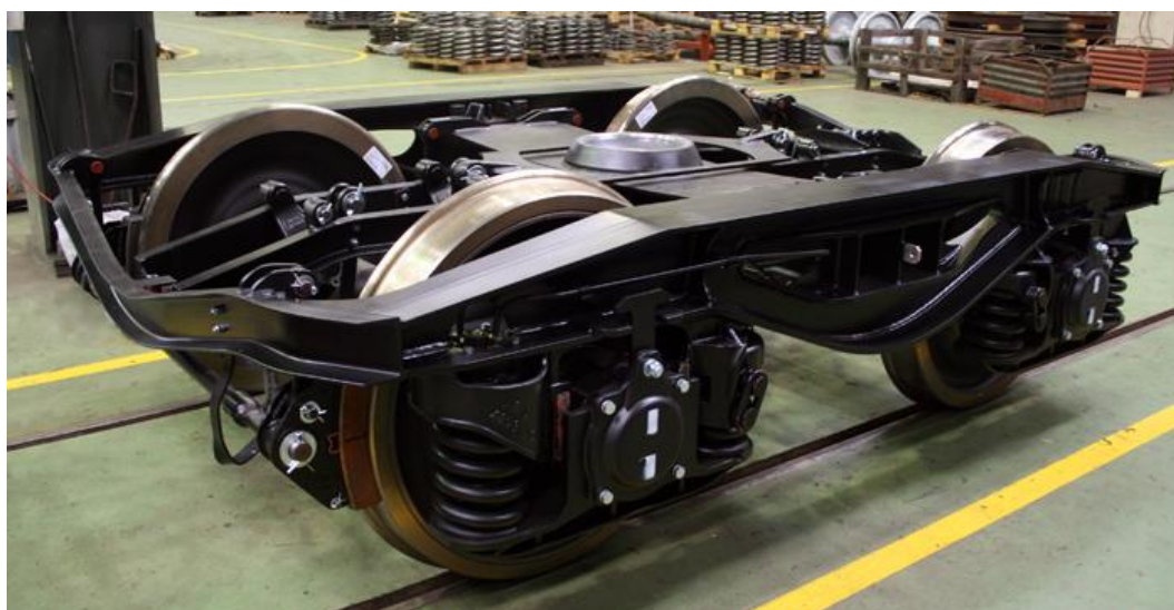
Рис. 2.19. Двовісний візок колії 1435 мм моделі Y25
