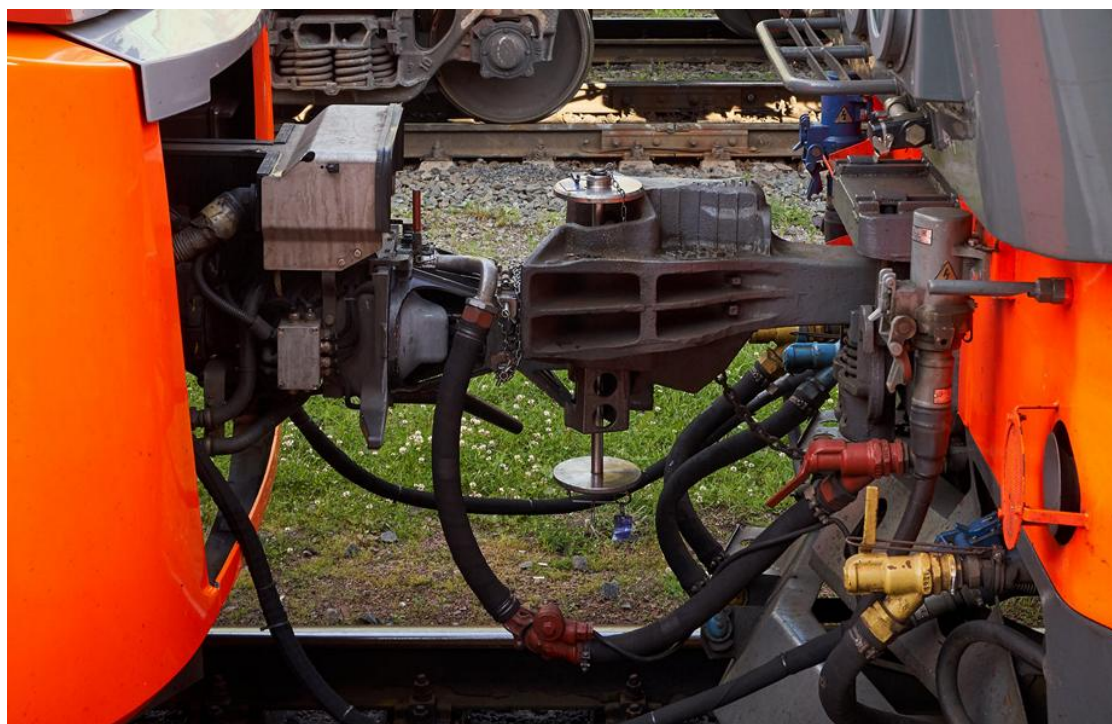
Рис. 4.10. Перехідник для автозчеплень Шарфенберга та СА-3
