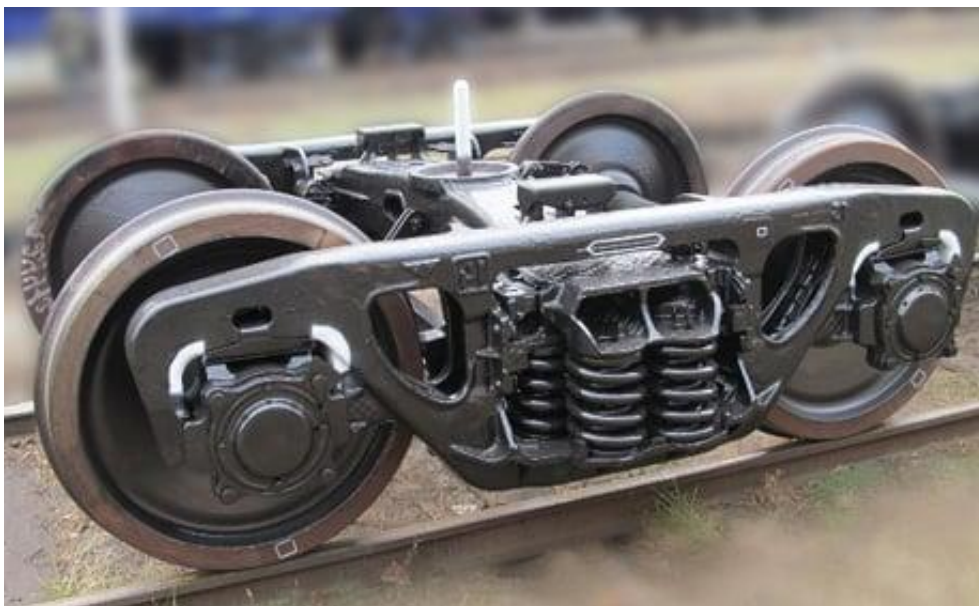
Рис. 2.18. Двовісний візок колії 1520 мм моделі 18-100
