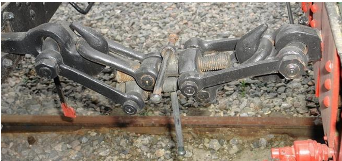
Рис. 4.3. З'єднання вагонів двома гвинтовими стяжками
