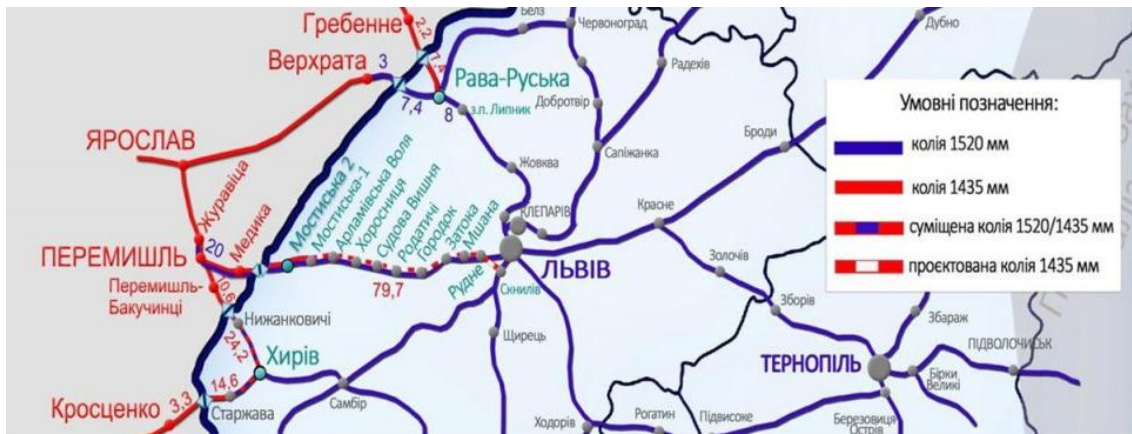
Рис. 2.4. Схема розміщення перевантажувальних комплексів на дільниці Держжордон – Мостиська II – Скнилів
