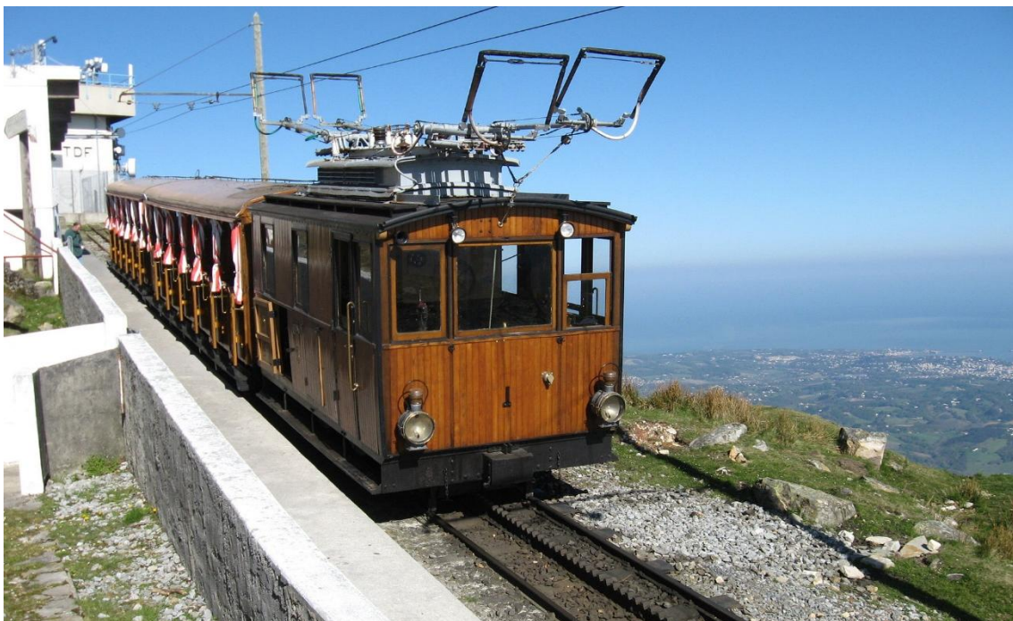
Рис. 8.1. Зубчасто-рейкова залізниця La Rhune у Франції
