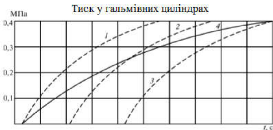
Рис. 9.5. Діаграма наповнення гальмівних циліндрів у вантажному поїзді при екстреному гальмуванні:
