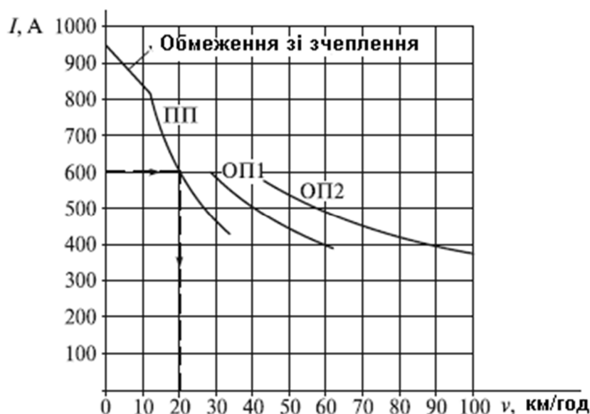
Рис. 10.1. Характеристика струму тягового електродвигуна ЭД118 в залежності від швидкості руху тепловоза М62
