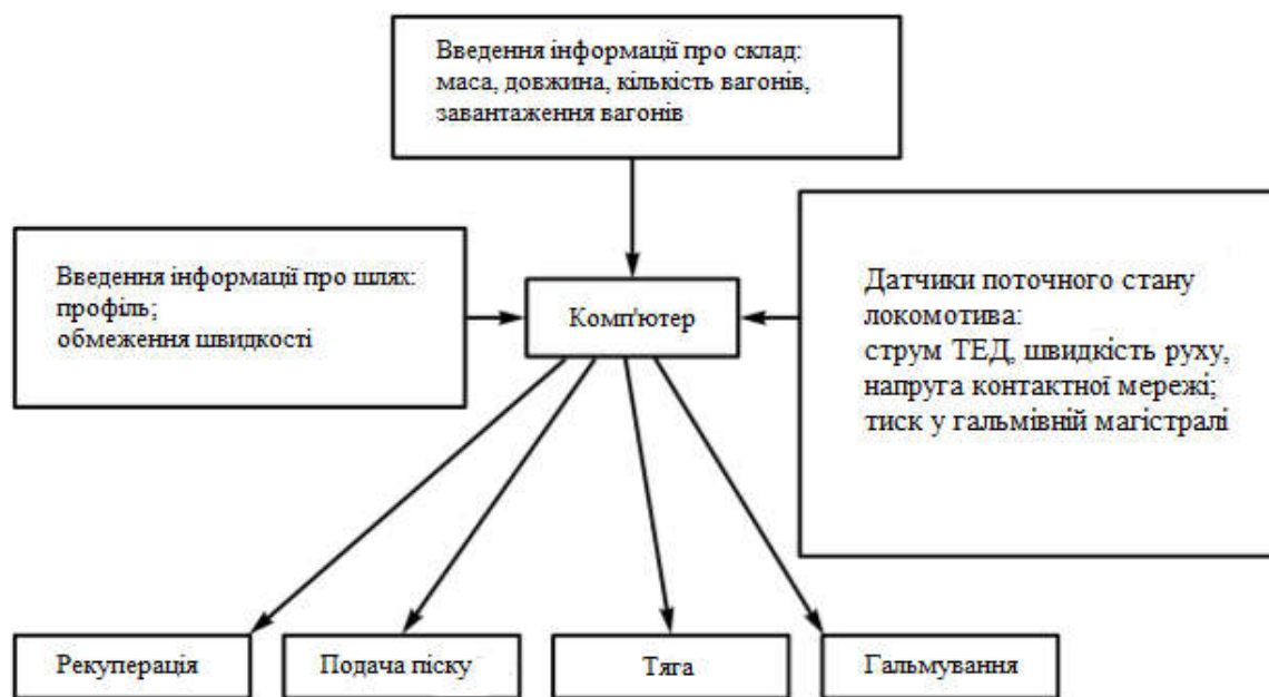
Рис. 13.3 Принцип роботи системи автоведення
