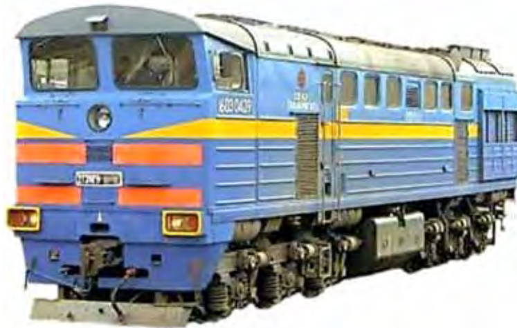
Рис. 2.5. Тепловоз 2ТЕ10У з тяговими електромашинами постійного струму
