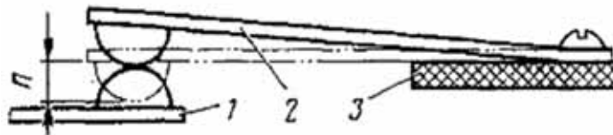
Рис. 9.3. Схема вимірювання провалу контактів електричних апаратів: 1 – нерухомий контакт; 2 – рухомий контакт; 3 – контактотримач; П – провал
