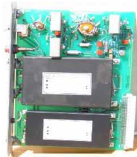
Рис. 16.11. Плата модуля живлення ПИТ
