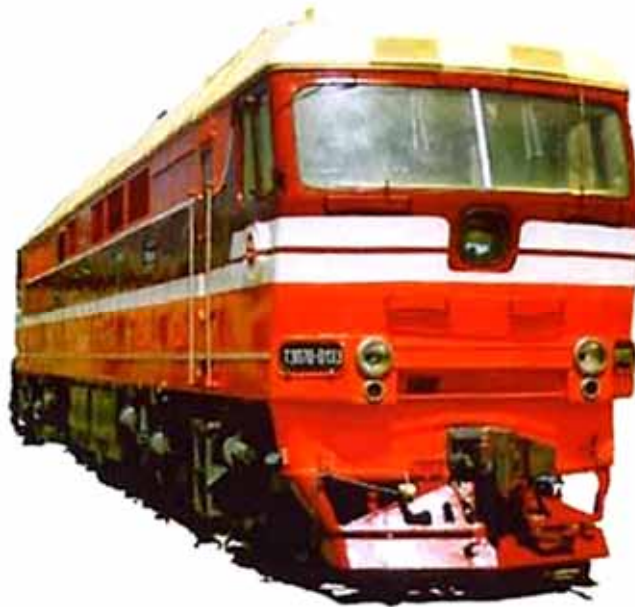
Рис. 6.9. Пасажирський тепловоз ТЕР70 з електродинамічним гальмуванням
