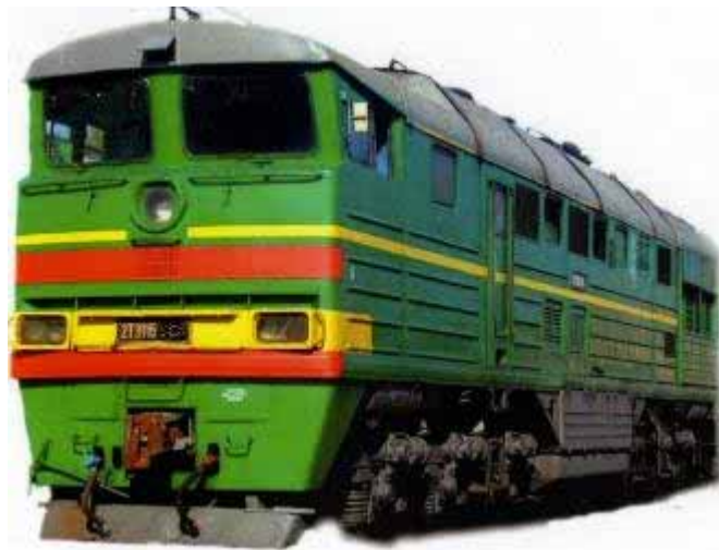
Рис. 2.7. Тепловоз 2ТЕ116 з електричною передачею змінно-постійного струму
