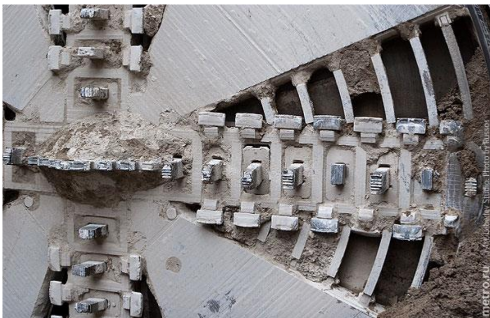
Рис.13.2. Стрижневі різці закріплені на робочому орані щита
