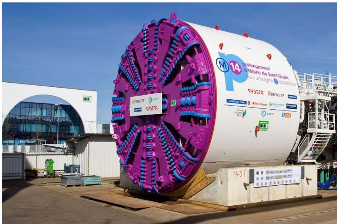
Рис. 15. 5. ЕРВ (Earth Pressure Balance) Schild німецької фірми «Herrenknecht» на будівельному майданчику.
