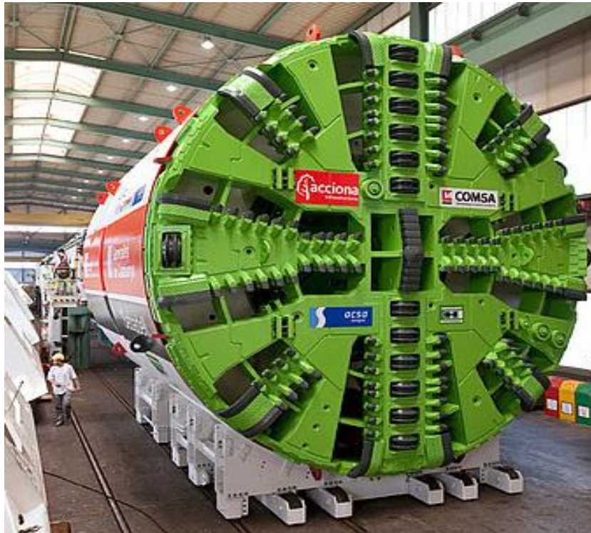
Рис.13.4. Робочий орган щита оснащений різцями дискового типу.
