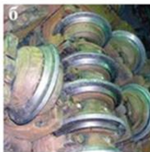
Рис. 13.7. Схеми розташування ріжучого інструменту на робочих органах щитів: а, б – шарошки дискового типу, в – стрижневі різці
