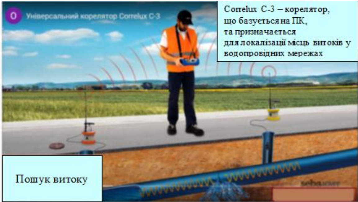
Рис. 8.7. Пошук витоків у водопровідній мережі
