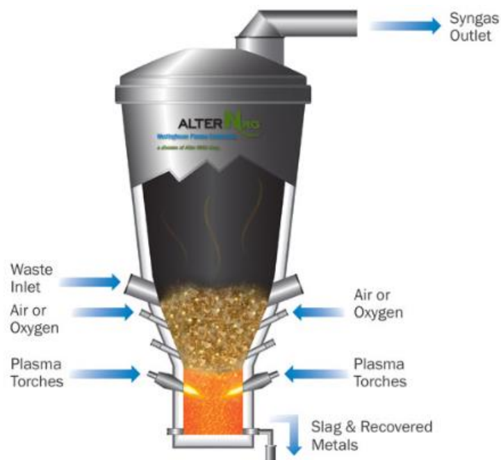
Рисунок 5.4 – Установка плазмової газифікації Alter NRG [35]
