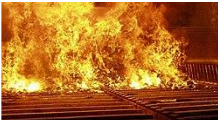
Рисунок 5.7 – Вигляд колосникової решітки всередині топкового агрегату [38]
