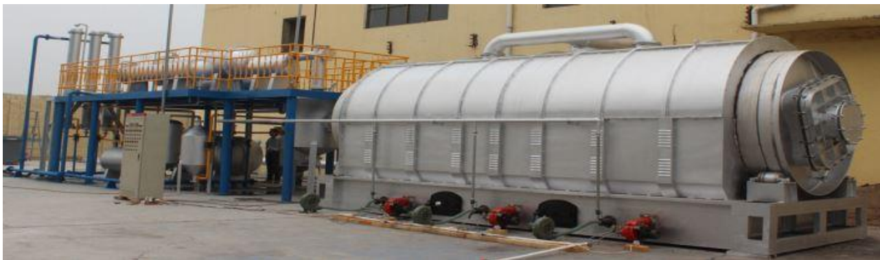
Рисунок 10.4 – Повністю автоматична машина піролізу відходів шин моделі REALTOP [59]
