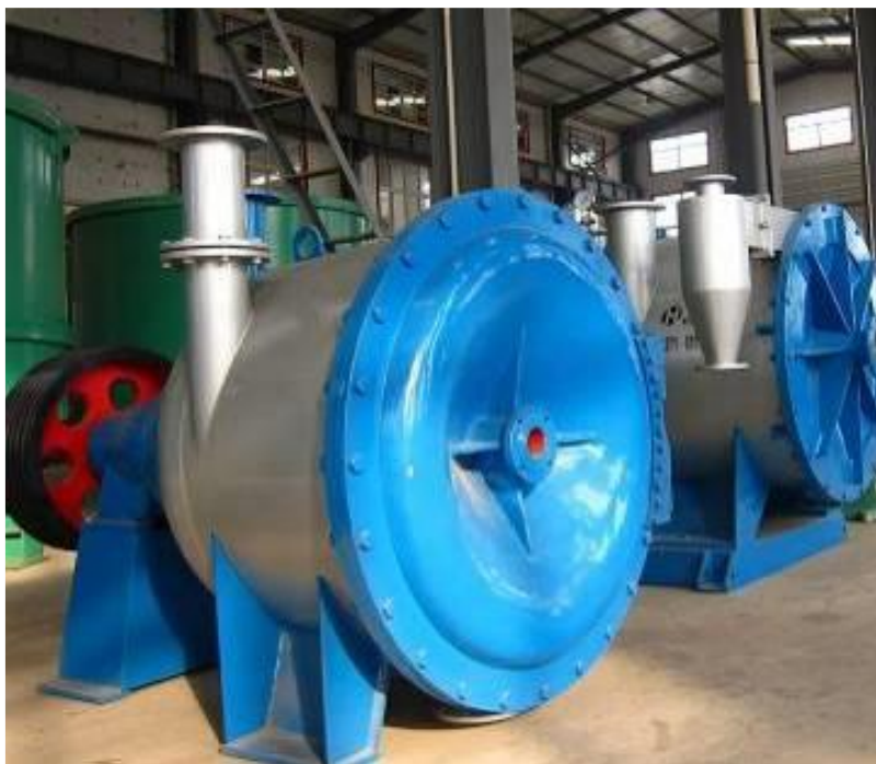
Рисунок 12.9 – Турбосепаратор для разволокнення макулатурної маси
