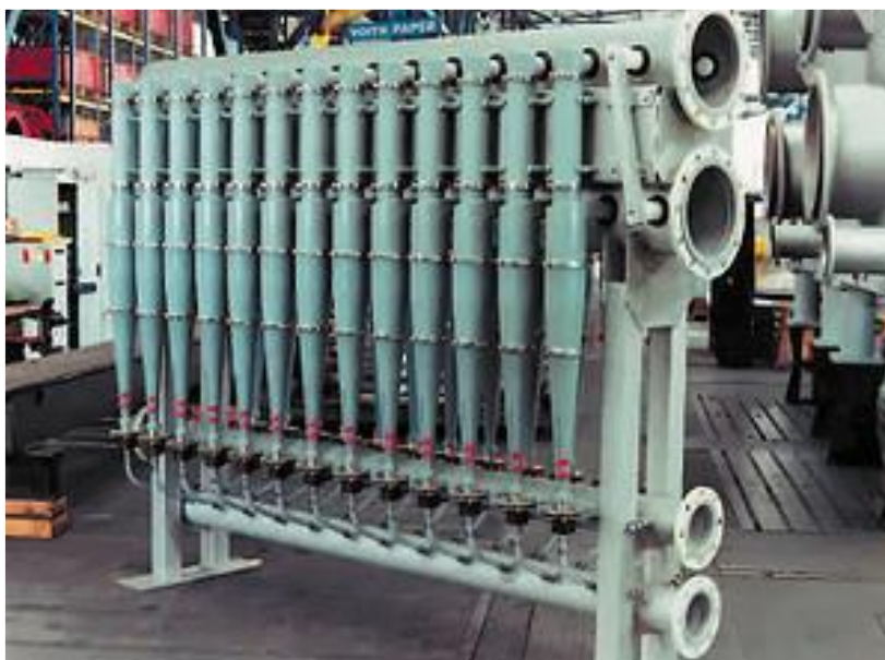
Рисунок 12.10 – Гідроциклони для очищення макулатури – зовнішній вигляд установки
