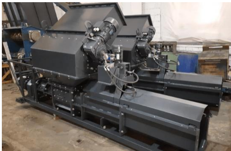
Рисунок 6.8 – Шнекові компактори від Екополімер [45]
