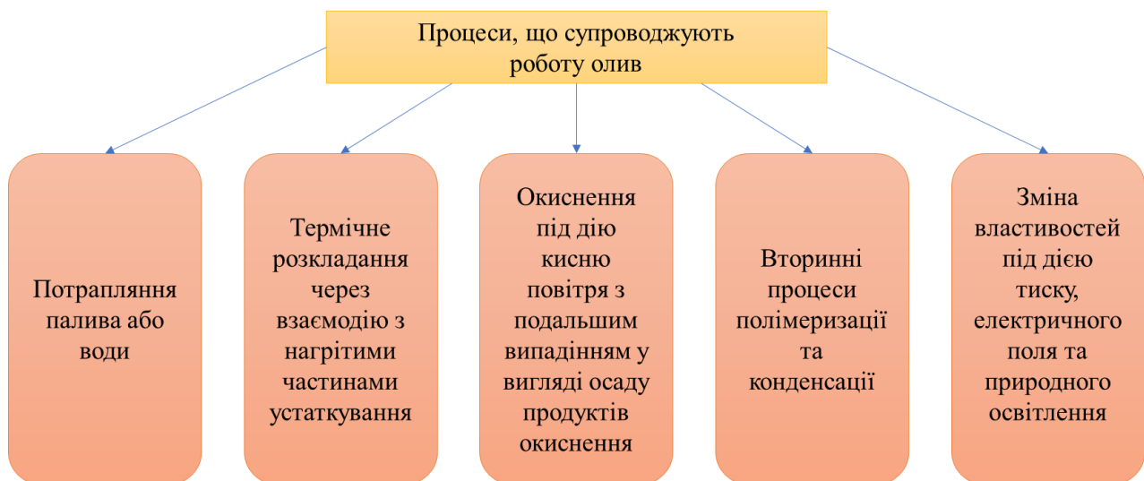
Рисунок 11.2 – Процеси, що супроводжують роботу оливи
