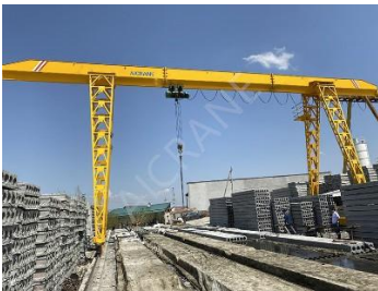
10 ton gantry crane
