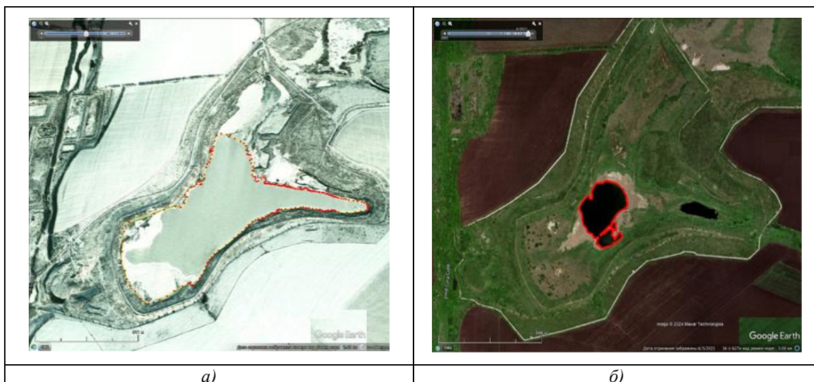
Рис. 1. Фото загального виду на хвостосховище «Сухачівське» секція II Червоним кольором позначено фактичний контур «дзеркала» на карті а) фото зроблено 23.02.2004 р. ( Google Earth Pro ); б) фото зробленого 08.07.2022 р. ( Google Earth Pro ). Виміри для ізоліній (сітки рельєфу) зроблені 25.09.2023 р.
